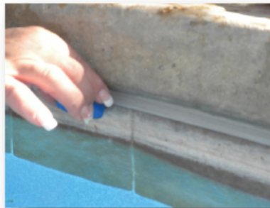
Ριχνουμε οξύ στη πουρι για να ελέγχουμε αν είναι ασβέστιο
